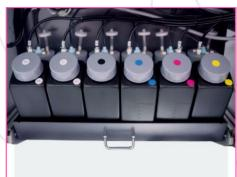
Il sistema di alimentazione automatica dell'inchiostro monitora e controlla i livelli di inchiostro dei serbatoi principali o secondari con sensori di livello del liquido. Offriamo una gamma di inchiostri UV con colori brillanti, nonché di eccellente durezza, durata e resistenza ai graffi, agli agenti chimici e all'acqua.
