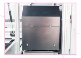
Il sistema di protezione automatica delle testine di stampa monitora se le testine di stampa saranno graffiate o esposte a luci UV, garantendone efficacemente la sicurezza. Basato su un concetto di design all-in-one, il piccolo e compatto modulo di manutenzione delle testine di stampa consente lo spurgo, la pulizia e la tappatura automatici per un comodo funzionamento senza supervisione.
