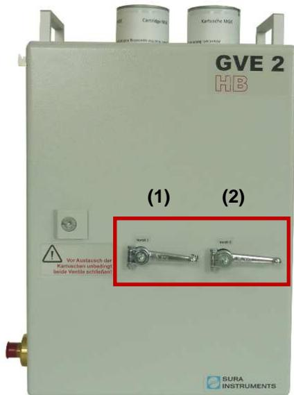
Figura 4: Chiusura delle valvole
