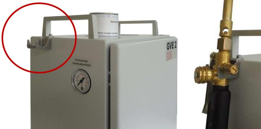
Figura 13: Fissaggio al gancio di supporto
