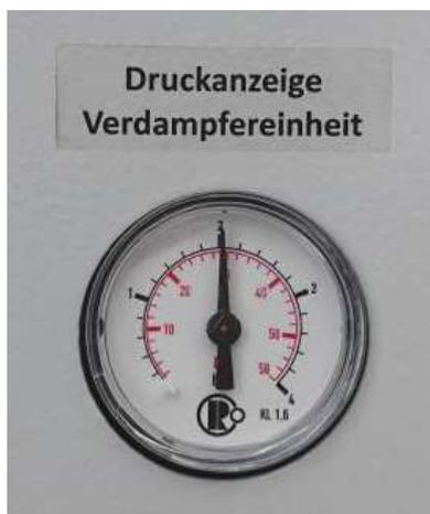
Figura 7: Indicazione di pressione 2 bar
